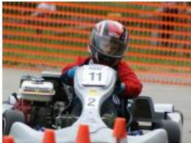
Die Zeit, in der Kinder mit dem Kettcar per Muskelkraft um die Wette fahren, ist vorbei. Längst hat ein 5,5-PS-Viertaktmotor den Pedal-Kettenantrieb ersetzt und das Chassis lässt den Vergleich nur noch erahnen.
